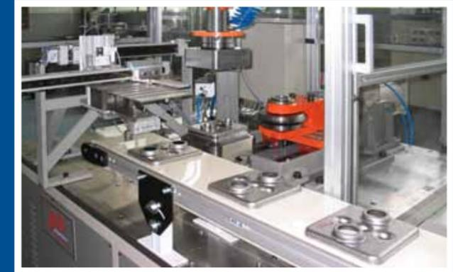
**AUTOMATISCHES BESCHNEIDEN TIEFGEZOGENE TEILE - AUTOMATIC SYSTEM TO DRAW PART**
